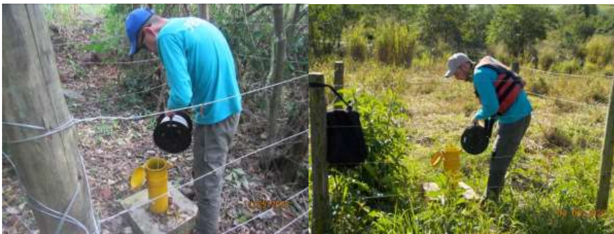
Figura 7 - Procedimento de medição da profundidade do lençol freático, na área de influência da UHE Baixo Iguaçu.
