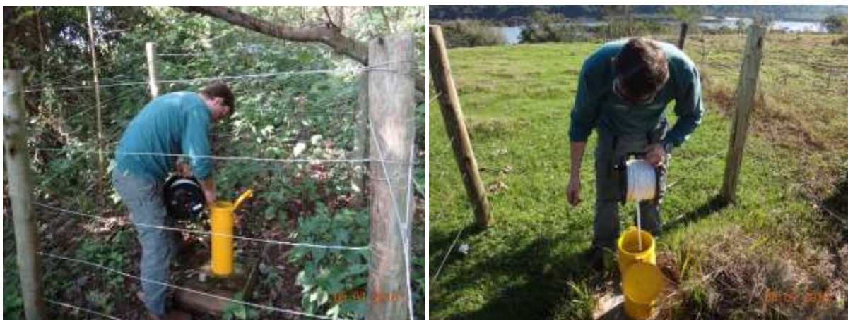
Figura 7 - Procedimento de medição da profundidade do lençol freático, em julho de 2018.
