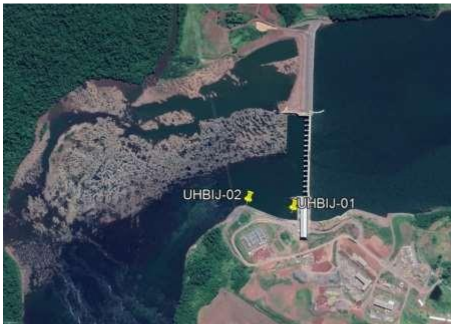
Figura 3 - Localização dos pontos de amostragem de água que passa pelo tratamento com MXD-100, para realização de ensaios ecotoxicológicos.
