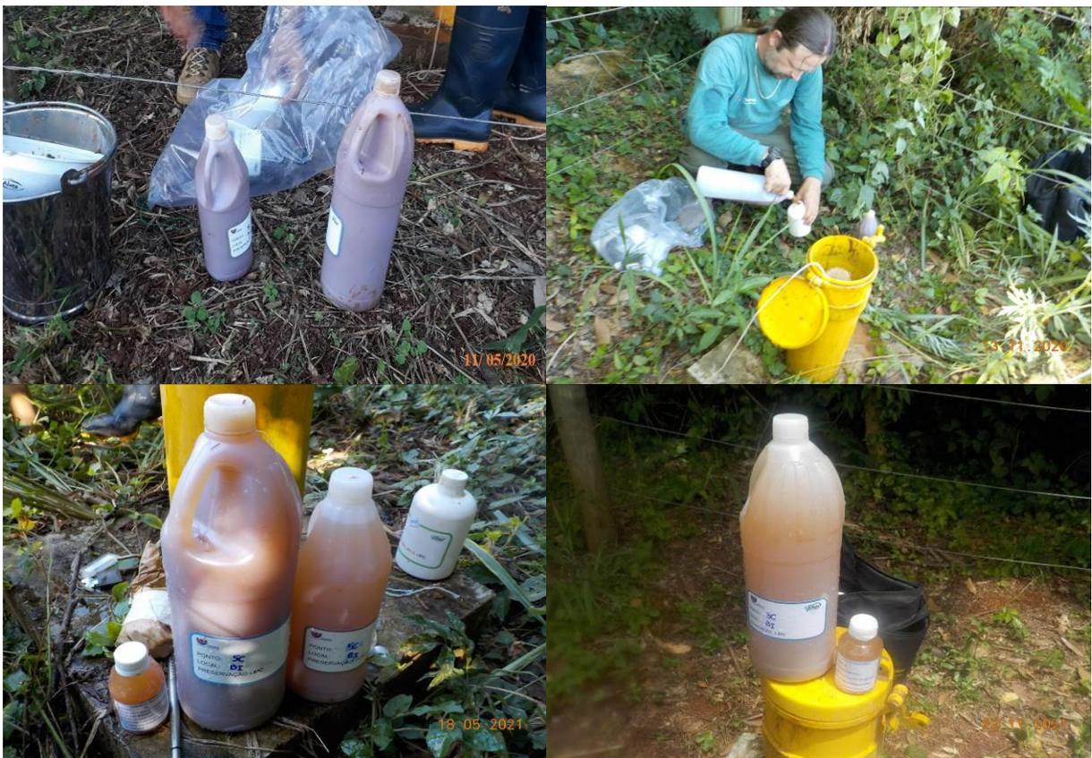
Figura 41 – Amostra de água obtida no poço 5C, demonstrando a cor da água.
