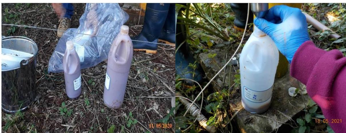
**Figura 9**- Procedimento de coleta da água, com amostrador Bailer 429.
