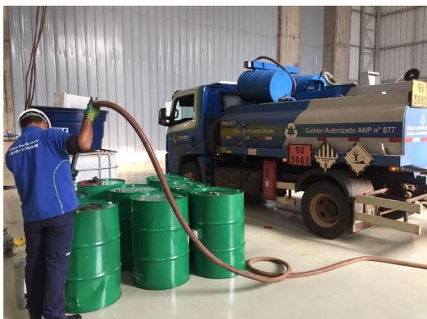
**Figura 07** Coleta de óleo contaminado casa de força
