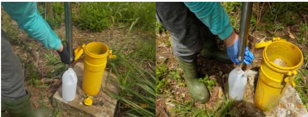
Figura 16 - Procedimento de coleta da água, com amostrador Bailer 429.
