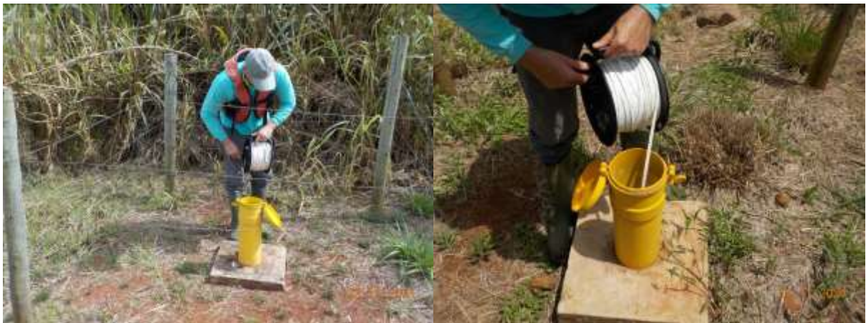
Figura 7 - Procedimento de medição da profundidade do lençol freático, na área de influência da UHE Baixo Iguaçu.
