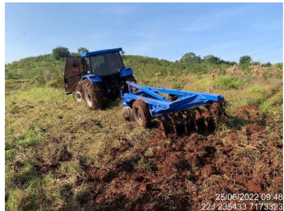
Trator com grade aradora de 28", utilizado nas atividades de gradagem
