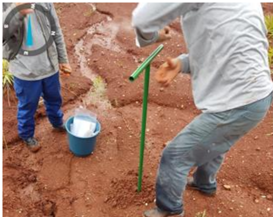
Utilização de trado para coleta de amostra de solo
