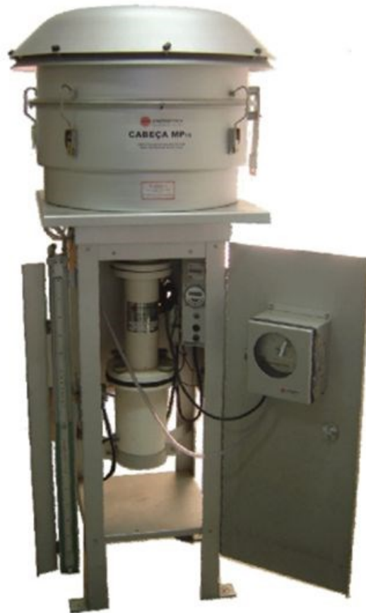
AMOSTRADOR DE GRANDE VOLUME (AGV) PARA PARTÍCULAS DE ATÉ 10 \mu\text{m} (MP 10 )
