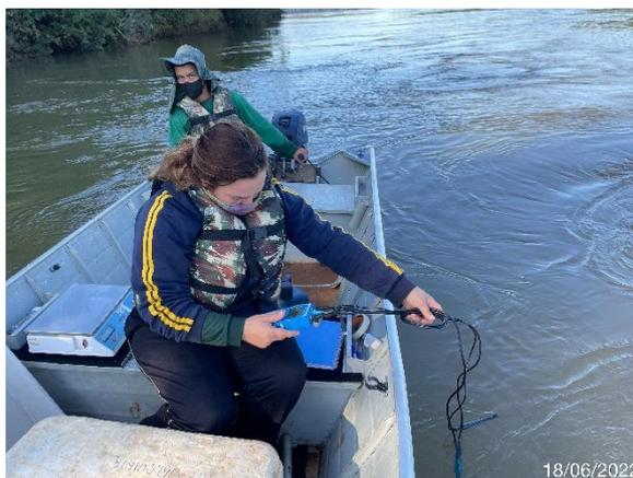
**Figura 38.** Aferição de parâmetros abióticos da água com sonda multi-parâmetros, junho de 2022.
