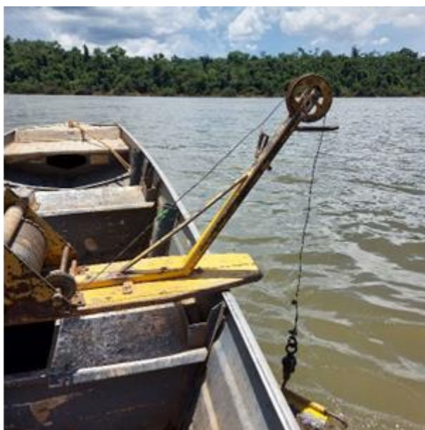
Figura 12 – Amostrador de sedimento em suspensão – Estação UHE Baixo Iguaçu Jusante
