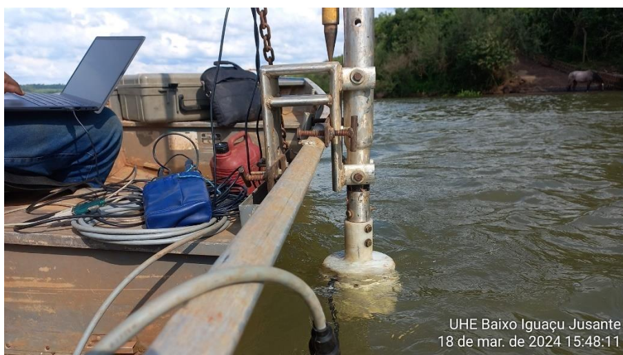
Figura 11 – Medição Descarga líquida com ADCP na estação UHE Baixo Iguaçu Jusante 18/03/2024
