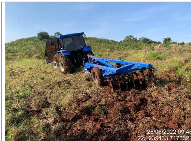
**Figura 19: Trator New Holland TL 75 com grade aradora de 28”, utilizado nas atividades de gradagem.**
