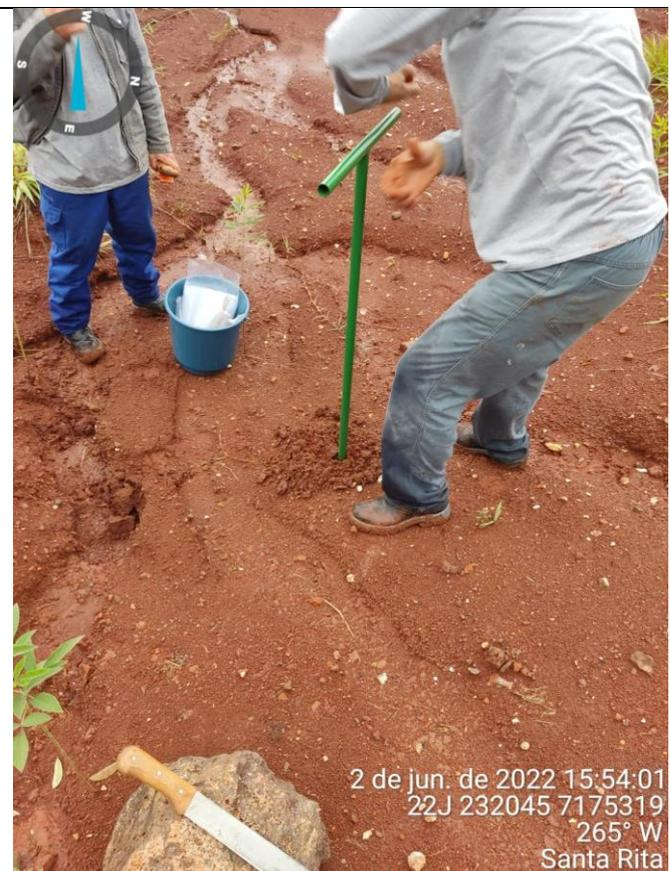
**Figura 9: Utilização de trado para coleta de amostra de solo.**
