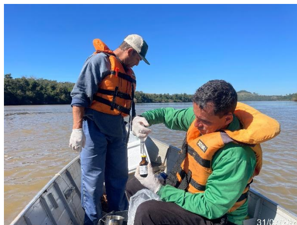
Filtragem de amostra in situ para análises laboratoriais
