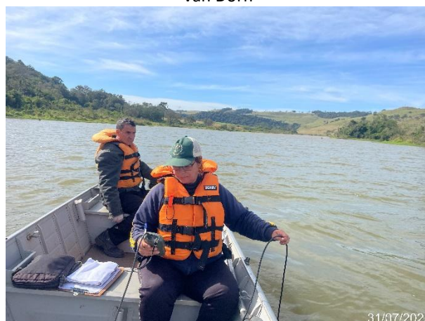
Realização de perfis verticais com sonda multiparâmetros
