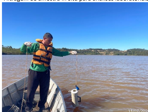
Coleta de água em profundidade com uso de Garrafa de van Dorn
