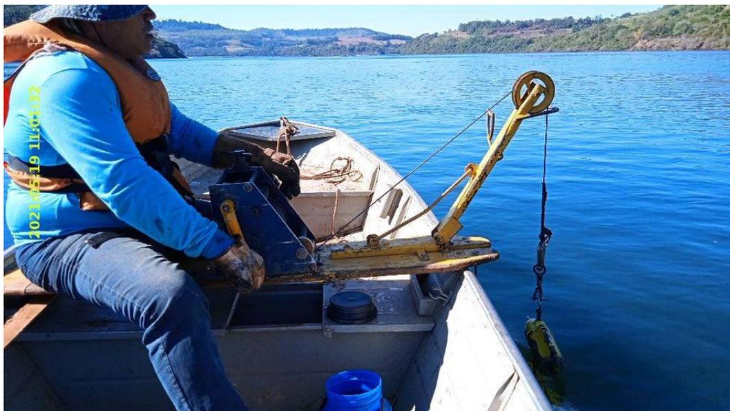
**Figura 12 – Amostrador de sedimento em suspensão – Estação UHE Baixo Iguaçu Jusante**
