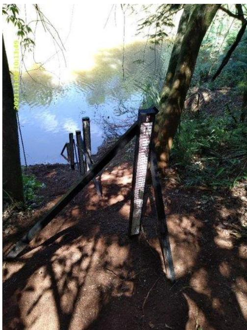
**Figura 55 – Seção de réguas UHE Baixo Iguaçu Rio Gonçalves Dias**
