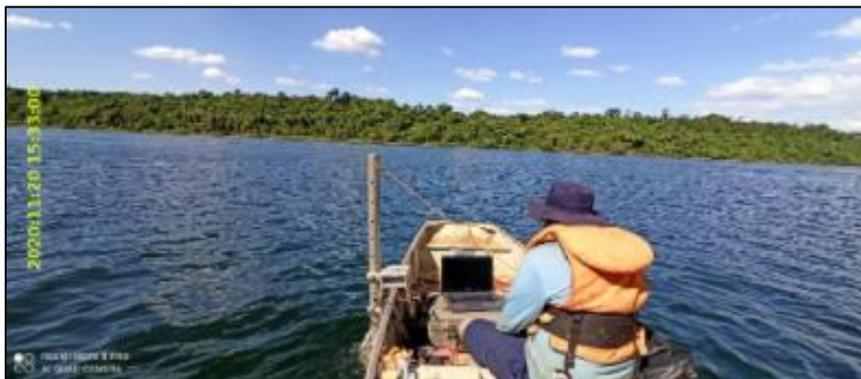
**Figura 11 – Medição Descarga líquida com ADCP na estação UHE Baixo Iguaçu Jusante 20/11/2020**
