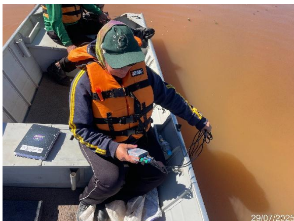
Figura 22. Aferição de parâmetros abióticos da água com sonda multi-parâmetros, julho de 2025.
