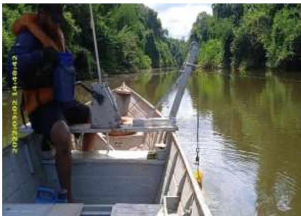
Amostragem de Sedimento em Suspensão realizada na estação Rio Gonçalves Dias – 02/03/2022.
